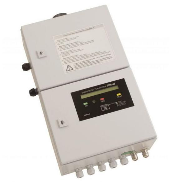
Dazu werden in der Regel die bestehenden Leitungen der CO<sub>2</sub>-Feuerlöschanlage genutzt, durch welche kontinuierlich Luftproben aus den Laderäumen angesaugt werden. Im Rauchmeldesystem selbst wird die Luft aus den Laderäumen auf Rauch untersucht und durch Lüfter aus dem Schiff geblasen. Das Rauchmeldesystem ist explosionsgeschützt.
